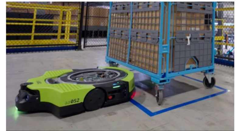
Robot mòbil autònom (AMR) d'Amazon Font: Robotics & Automation Magazine
