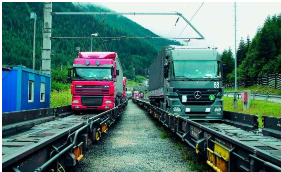
RoLa: autopista ferroviària
